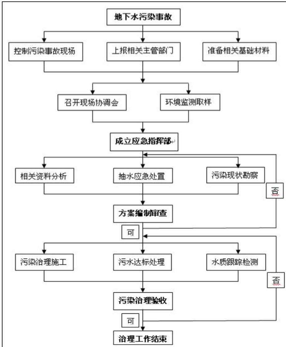
图 5.2-5 污染应急治理程序框图
