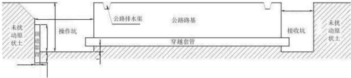
图 3.3-3 穿越道路施工作业示意图
