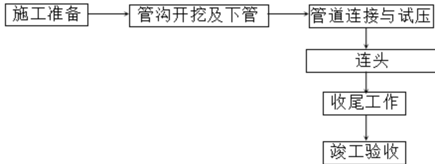
图3.2-4 施工方案工艺流程图
