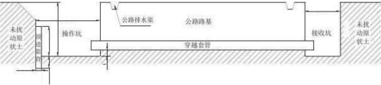
图 3.2-3 穿越道路施工作业示意图
