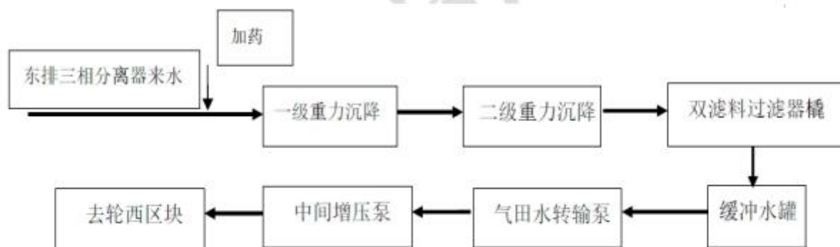
图 3.4-2 2800m 3 /d 采出水处理系统工艺流程图
