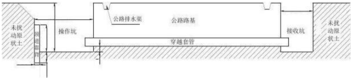
图 3.4-2 穿越道路施工作业示意图
